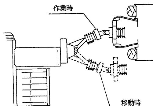
6. トラクタロワーリングをパワージョイントが抜けない上限位置まで持ち上げてください。
