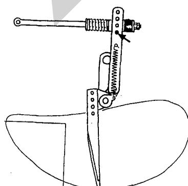
② 本作業機の後方から見て、左側の密度が高く、右側の密度が低い変形梱包が発生した時は、フォークロットの位置を上にしてください。(短い草や水分の高い時、発生しやすい。)
