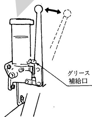
(2) グリースが完全に給油されたかどうかの確認は分配弁の指示棒の往復運動によって確認することができます。図示の指示棒が1往復すれば、すべての軸受部に給油が完了したことを示します。
