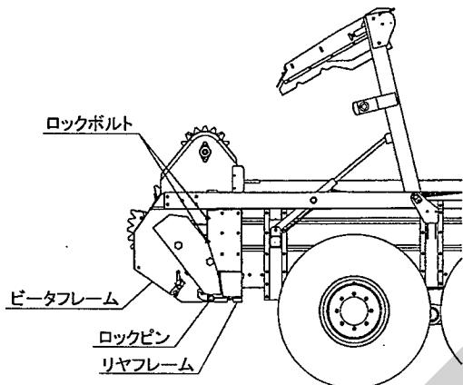
2. 運搬堆積作業でパワーゲート、ビータ共に昇降させるとときは、ロックpinをパワーゲートのアームとビータフレームのアームの連結部に差し、抜け止めにリンチpinを差してください。
