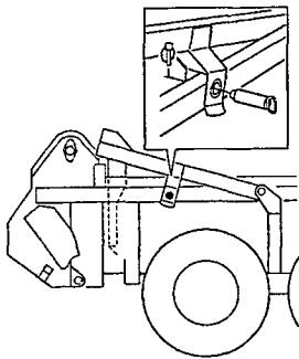
3. 運搬堆積作業から散布作業に切り替えるときは、機械にかかっている堆肥等を取り除いてください。特に下図で示す部分に堆肥が乗っていると、ビータフレームとリヤフレームの連結が行えなくなりますので必ず取り除いてください。又、ギヤのカバー内にたまっている堆肥も取り除いてください。
