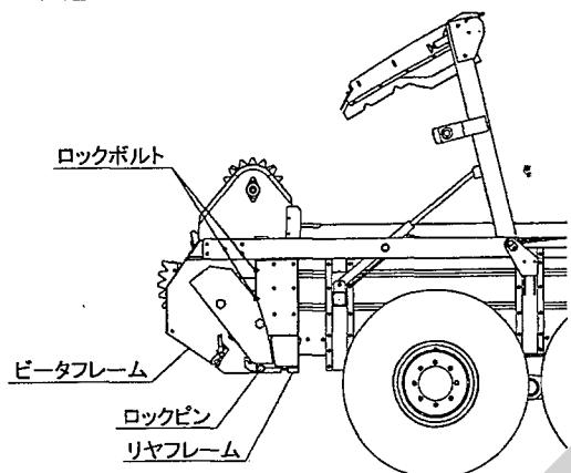
2. 運搬堆積作業でパワーゲート、ビータ共に昇降させることは、ロックpinをパワーゲートのアームとビータフレームのアームの連結部に差し、抜け止めにリンチpinを差してください。
