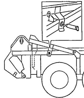
3. 運搬堆積作業から散布作業に切り替えるときは、機械にかかっている堆肥等を取り除いてください。特に下図で示す部分に堆肥が乗っていると、ビータフレームとリヤフレームの連結が行えなくなりますので必ず取り除いてください。又、ギヤのカバー内にたまっている堆肥も取り除いてください。
