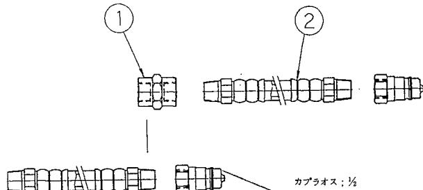
本作業機についているカプラオス； $\frac{1}{2}$ をはずし、①ソケット、②ユアツホースを取り付け、その先にカプラオス； $\frac{1}{2}$ を取り付けてください。
