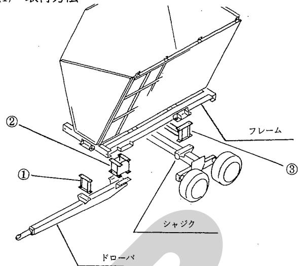
上図のようにドローバおよびシャシクとフレームの間に①②③のブラケットを、はさみ込み、ボルトで固定してください。
