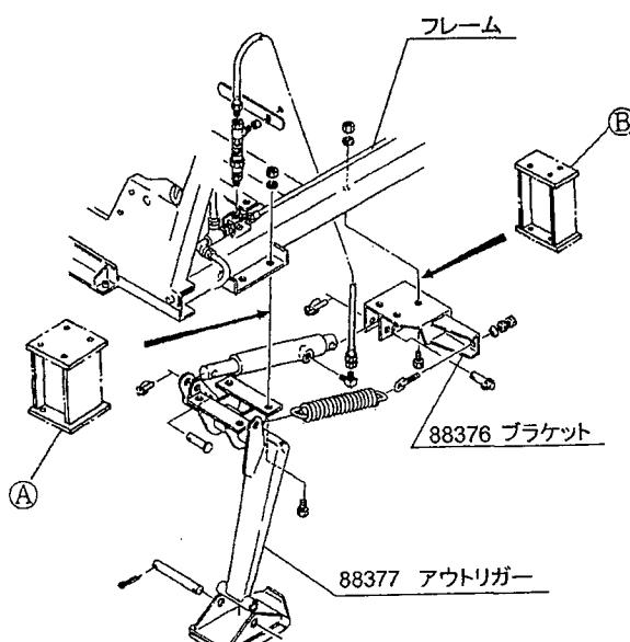
ⒶⒷのブラケットをフレームと88377アウトリガー、88376ブラケットの間にそれぞれはさみ込み、ボルトで固定してください。
