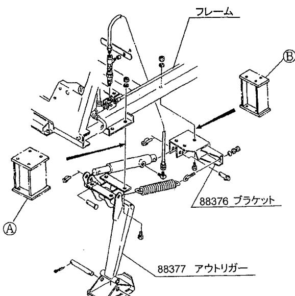
ⒶⒷのプラケットをフレームと88377アウトリガー、88376プラケットの間にそれぞれさみ込み、ボルトで固定してください。
