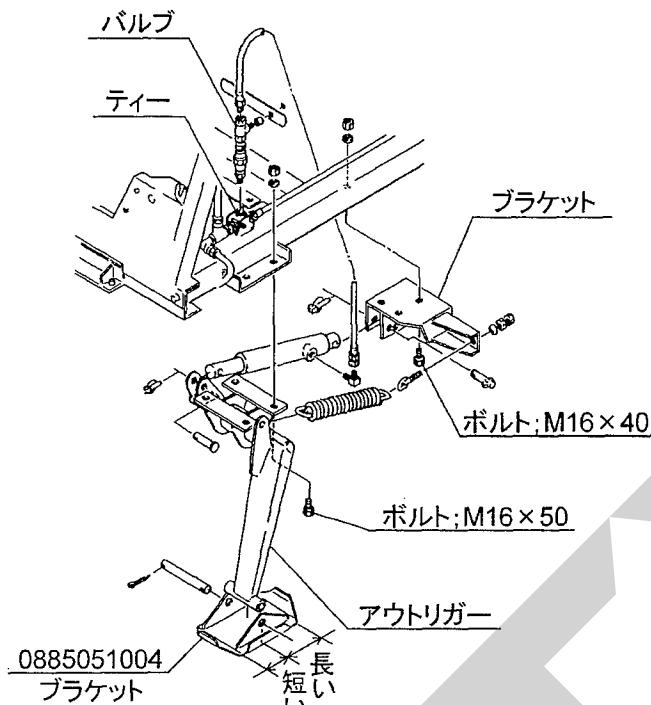
① ブラケット ② アウトリガーをそれぞれフレームにボルトで取り付け、油圧シリンダ、スプリング及び油圧の配管を行ってください。
