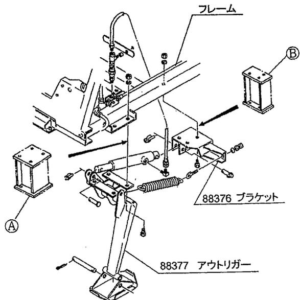
④のブラケットをフレームと88377アウトリガー、88376ブラケットの間にそれぞれはさみ込み、ボルトで固定してください。
