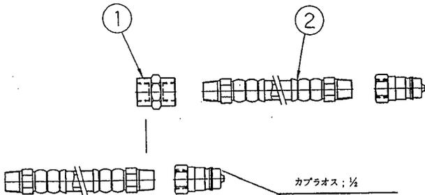
本作業機についているカブラオス; 1/2をはずし、①ソケット、②ユアツホースを図のように取り付け、その先にカブラオス; 1/2を取り付けてください。
