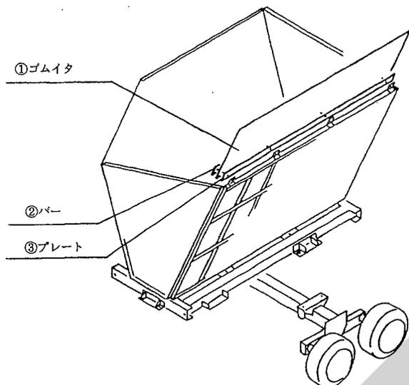
図のように③プレート、①ゴムイタ、②バーの順に本体へボルトで固定してください。
