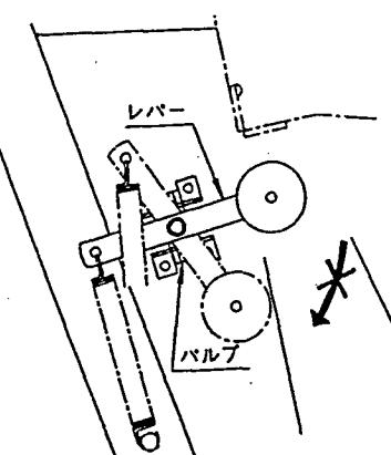
3. バケット内の収穫物を運搬車に移し終えたら、外部油圧操作レバーを逆方向に操作し、バケットが降りきるまで降下させてから積み込み作業を始めてください。
