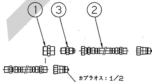
本作業機についているカプラオス；1/2をはずし、①ソケット、②ユアツホース、③ホースニップルを図のように取り付け、その先にカプラオス；1/2を取り付けてください。
