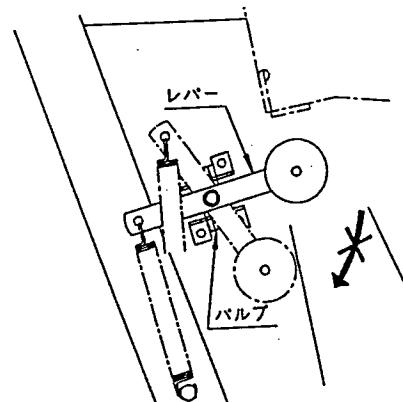
3. パケット内の収穫物を運搬車に移し終えたら、外部油圧操作レバーを逆方向に操作し、パケットが降りきるまで降下させてから積み込み作業を始めてください。
