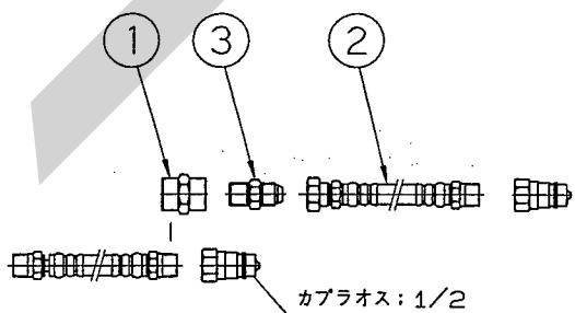
本作業機についているカプラオフス；1/2をはずし、①ソケット、②ユアツホース、③ホースニップルを図のように取り付け、その先にカプラオフス；1/2を取り付けてください。
