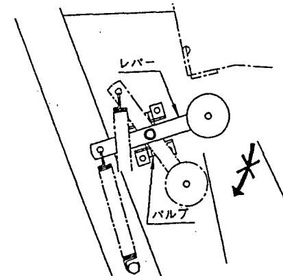
3. バケット内の収穫物を運搬車に移し終えたら、外部油圧操作レバーを逆方向に操作し、バケットが完全に降下し、アウトリガーが完全に上昇してから走行を始めてください。
