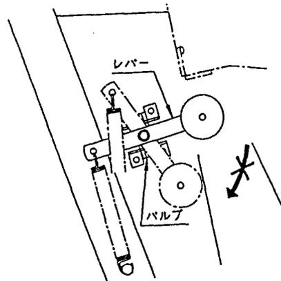
3. バケット内の収穫物を運搬車に移し終わったら、外部油圧操作レバーを逆方向に操作し、バケットが完全に降下し、アウトリガーが完全に上昇してから走行を始めてください。
