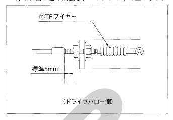
7 ①TFワイヤーをミッションフレームに巻き付け、 アウター部に②ワイヤーホルダーを取付け、図の通 り調整し、ロックナットで止めます。
