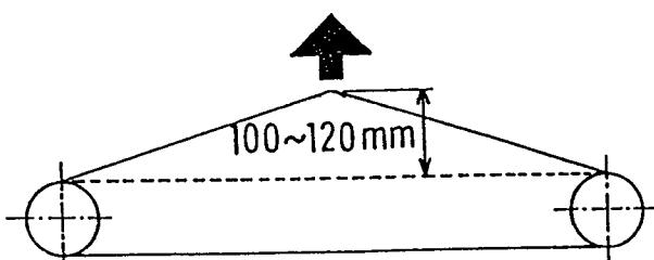
(2) 左右のコンベヤチェーンの持ち上がる量が同じになるように、左右のテンションボルトを締め込んでください。
