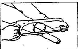
切断する時は、パイプの中にウェスを詰め、パイプ内面に切り粉が付着するのを防いでください。
