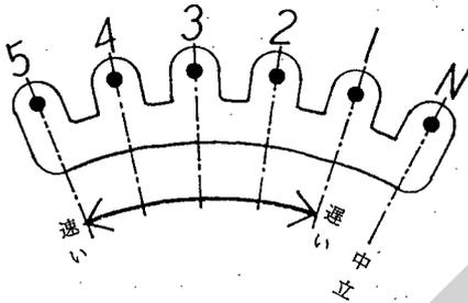
N (中立) にするとコンベヤは停止します。チェンジレバーを希望変速位置溝までスライドさせレバーをあげて、溝にはめこむと、変速操作は完了します。
