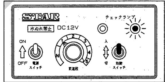
(4) チェンジレバーを「N」に戻すときは、始動スイッチを「切」にします。このときチェックランプが点灯します。
