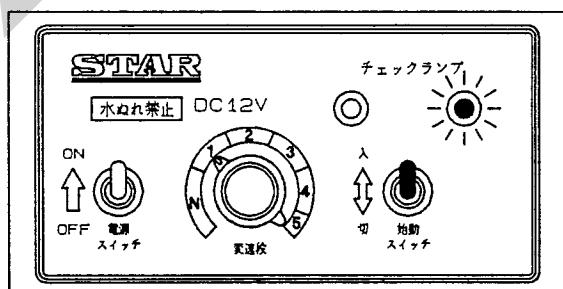
(4) チェンジレバーを「N」に戻すときは、始動スイッチを「切」にします。このときチェックランプが点灯します。
