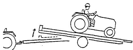
(9) アユミが地面についたら、再び、積載したトラクタやコンバインを動かし、トレーラから降ろしてください。
