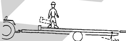
(12) フックが掛かっていることを確認してロックピンを挿入し、抜け止めにリンチピンを差してください。
