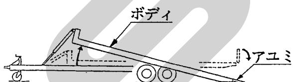
※ ボディ水平：ボディが水平になりはじめるのと連動してアユミが上がり、運搬状態になります。
