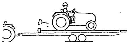
(11) 完全に水平になったら、10~20cmドローバー側に移動し停止してください。エンジンをとめ、駐車ブレーキをかけ、ギヤを1速に入れてください。
