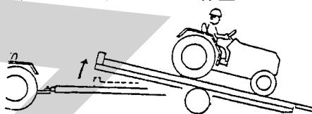
(9) アユミが地面についたら、再び、積載したトラクタやコンバインを動かし、トレーラから降ろしてください。
