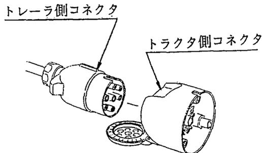
トラクタ側コネクタの電気配線が必要となります。作業機の電気配線は下図の通りです。
