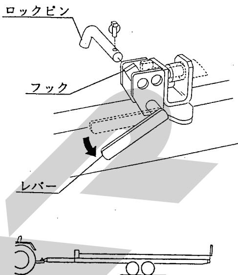
(5) フロント部を持ち上げ、ボディを傾斜させます。
