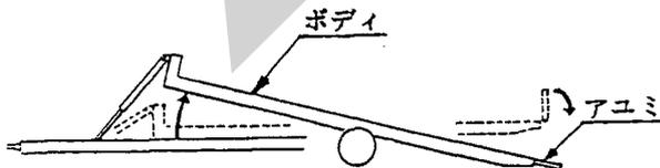
※ ボディ水平：ボディが水平になりはじめるのと連動してアユミが上がり、運搬状態になります。
