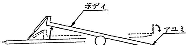
※ ボディ水平：ボディが水平になりはじめるのと連動してアユミが上がり、運搬状態になります。
