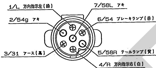
また、トラクタ側に外部電装品取り出し口が装備されていない場合は、トラクタ側コネクタの電気配線が必要となります。
