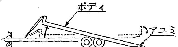
※ ボディ水平：ボディが水平はじめると運動してアユミが上がり、運搬状態になります。
