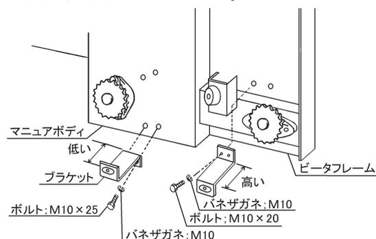
4. テンションローラのナットをゆるめ、ツギテの向きに注意してローラチェーンを掛けてください。カバーアッセを組んだとき、収まりが悪い場合は、ブラケットの取り付け位置を調整してください。
