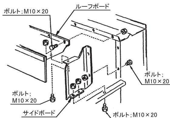
3. ブラケット2ヶのうち低い方のブラケットをマニュアルボディ側へ、高い方のブラケットをアタッチ側に組み付けてください。
