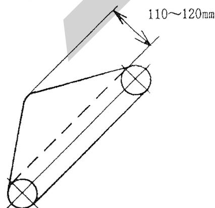
(2) 左右中央のコンベヤチェーンの持ち上がる量が同じになるように左右のテンションボルトを締め込んでください。
