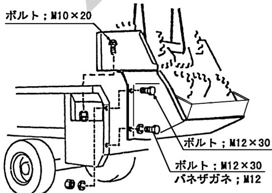
2. ブラケット2ヶのうち低い方のブラケットをマニユアボディ側へ、高い方のブラケットをアタッチ側に組み付けてください。
