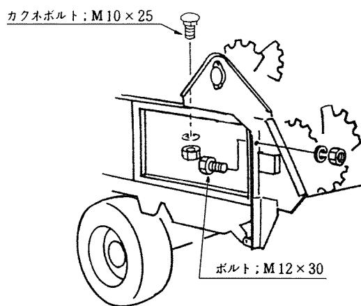
5. カバーアッセイをボルトを通してスプロケットにローラチェーンを掛けたままボスの向きに注意して組み込んでください。
