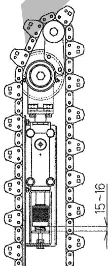
図示寸法が 15mm の時適正なテンションです。
