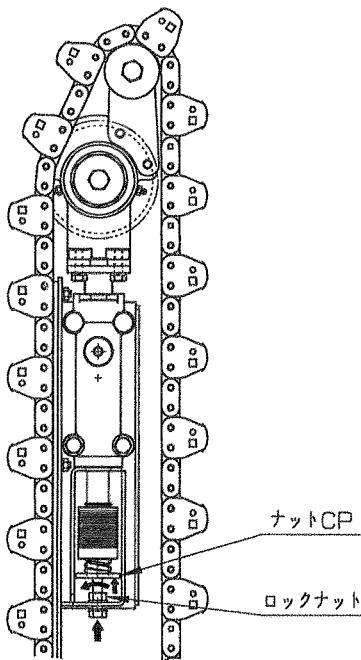
(5) スッパとナットCPの寸法(図示)が15mmとなるよう調整します。
