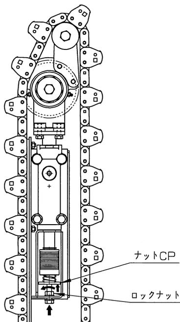
(5) ストップとナットCPの寸法(図示)が15mmとなるよう調整します。
