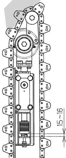
図示寸法が 15mm の時適正なテンションです。
