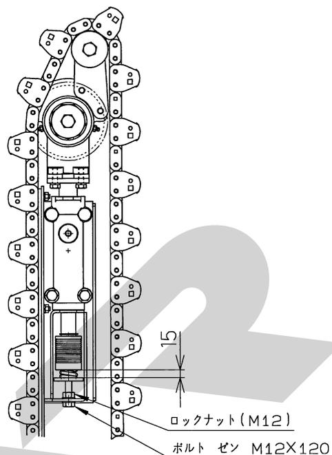
ギャザリングチェーンは60haを目安に交換してください。使用後の給油が十分でない場合、上記面積にいたらないで、チェーンピン部に異常なガタが発生することがあります。この時はただちにギャザリングチェーンを交換してください。
