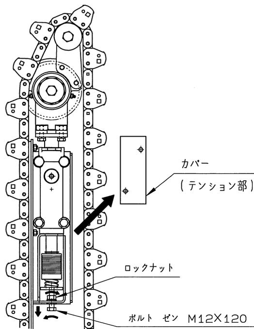
(4) ボルトの頭を押さえながらロックナットを締めるとナットCPが図示上方向に移動しスプリングが縮みます。
