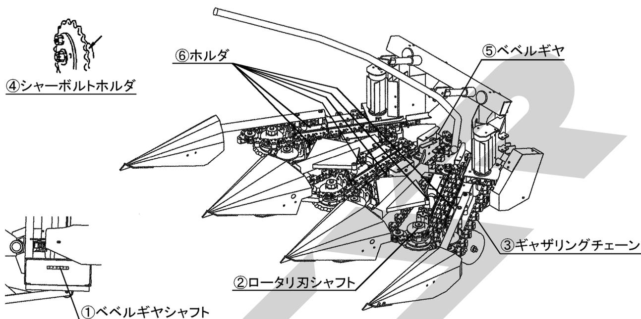
表のNo.1, 2, 3は塵芥、汁等の混入による軸受け部の寿命低下を防止するため、下記要領で入念に給油してください。
