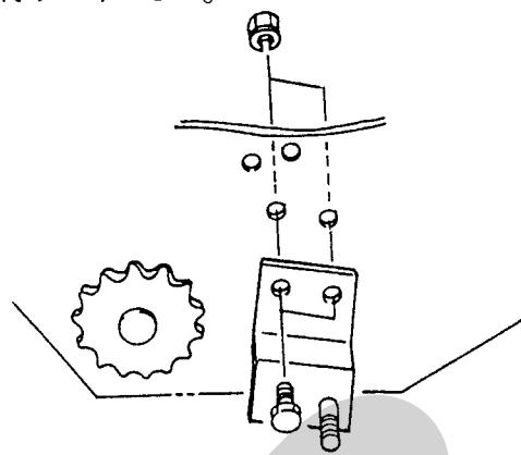
5. カバーアッセをボルトを通してスプロケットにローラチェーンを掛けたままボスの向きに注意して組み込んでください。
