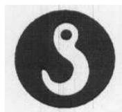
機械の吊り上げはこの場所を使用のこと。注意：吊り上げ時、機械の下に入るな。激突の危険あり。
