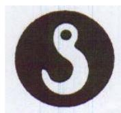
機械の吊り上げはこの場所を使用のこと。注意：吊り上げ時、機械の下に入るな。激突の危険あり。
