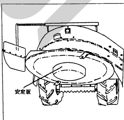
②作業状況に合わせて安定板の高さを調整して下さい。
