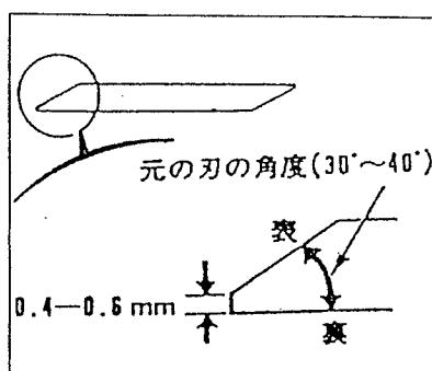
③刃先には0.4~0.6mm程度の平らな部分を残しておいて下さい。カミソリの様に刃先をとがらせると、すぐに刃先が磨耗し切れ味が鈍ります。
