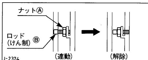
①ナット④をゆるめ、ロッド(けん制)②の主クラッチに当っている部分を右方向に引込みます。
