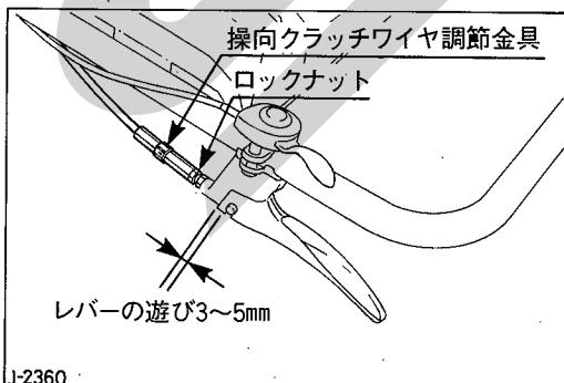
調節後はロックナットを確実に締付けてください。
