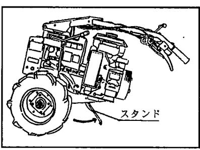
④本機を後方に移動させ、本機のスタンドをセットして作業の完了です。
