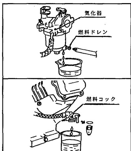
①本機を30日以上使用しないときは、燃料変質による始動不良、又は運転不調にならないように燃料ドレンボルトを緩め気化器内燃料を排出すると共に、燃料コックより燃料タンク内の燃料を抜き、湿気のない場所を選んで保管して下さい。
