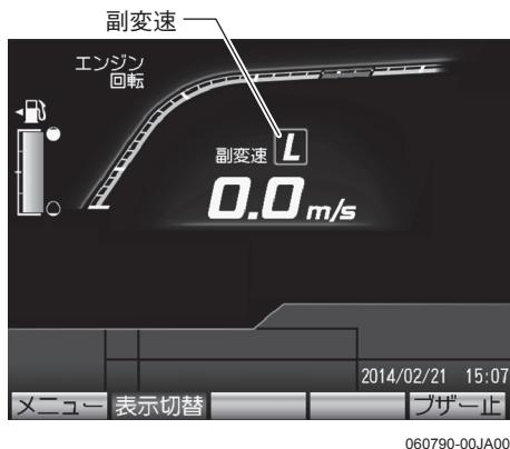
4. アクセルダイヤルで、エンジン回転を調節して作業を行う場合は、センターディスプレイのエンジン回転数が「グリーンゾーン」位置(1)を示すように調節します。または、エコモードスイッチ(2)を「入」(エコランプ点灯)(3)にします。
