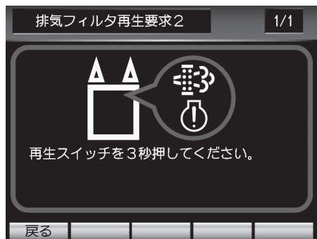
5. 排気フィルター再生スイッチを3秒以上長押しします。
