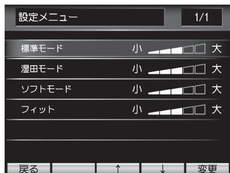
5. 「↑」(スイッチ)および「↓」(スイッチ)を押して、設定したい旋回力を選択します。「↑」(スイッチ)を押すごとに、旋回力が大きくなります。最大までになると最小になり、また押すごとに大きくなります。
