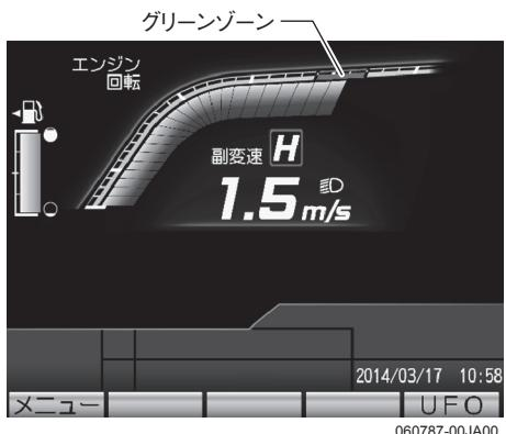
5. フィットステアリング・刈取昇降スイッチ(1)「上」側、またはオールマイティシフトレバー(2)の刈取昇降スイッチを「上」側にします。刈取部が上昇します。
