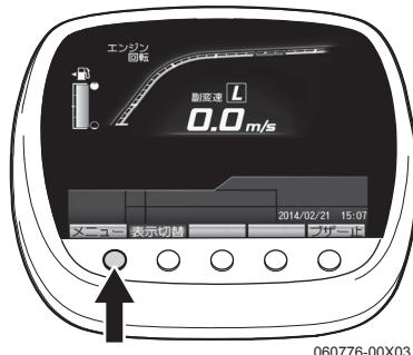
2.「↑」(スイッチ)および「↓」(スイッチ)を押して「コンバイン設定」を選択し、「決定」(スイッチ)を押します。
