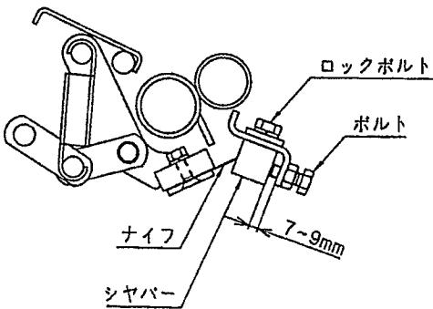
ロックボルトを $1/2$ 回転程度緩めてからボルトでナイフとシャバーのスキマがなくなるよう調整してください。
