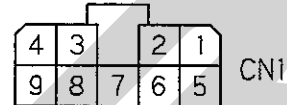
矢崎CNコネクタのピン配置 (コネクタ結合面から見て)
