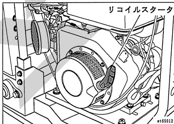
④エンジンが始動したら、エンジン回転の調子を見ながら、チョークノブを徐々に戻します。最後には必ず一杯戻してください。
