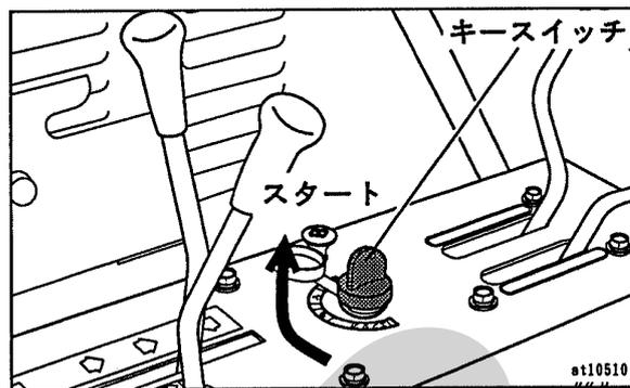
※走行クラッチレバーが「切」位置にないと始動安全スイッチが働かず、セルモータが回りません。走行クラッチレバーは確実に「切」位置にしてエンジンをスタートしてください。
