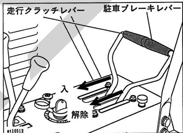
※走行中の変速は、機械の破損の原因になりますのでしないでください。
