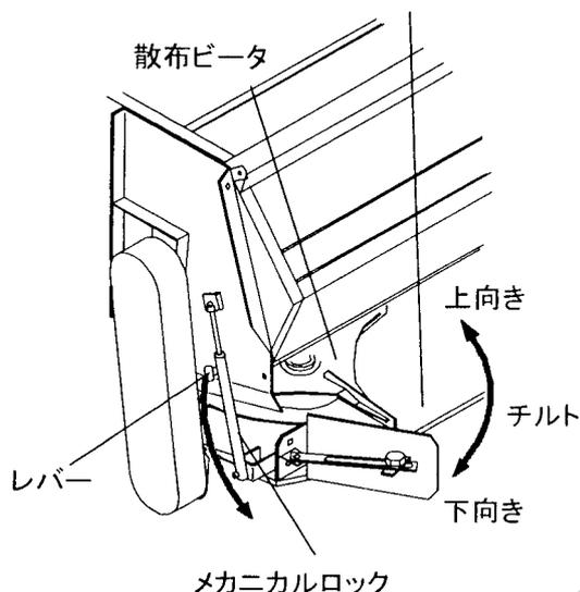
ディスクビータは散布ビータがチルト（傾く）して散布幅が変えられます。上向きにチルトさせると幅広散布、薄まきとなり、下向きにチルトさせると狭幅、厚まきとなります。
