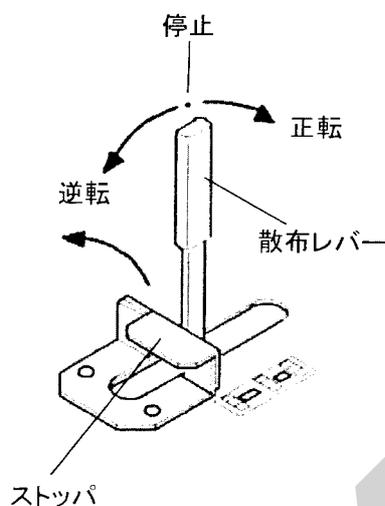
散布レバーを操作すると散布装置（ビータ、フロアコンベア）が作動して堆肥散布ができます。
