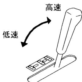
走行速度の範囲を高低2段階に切り換えるレバーです。前に押すと「高速」レンジ、手前に引くと「低速」レンジになります。
