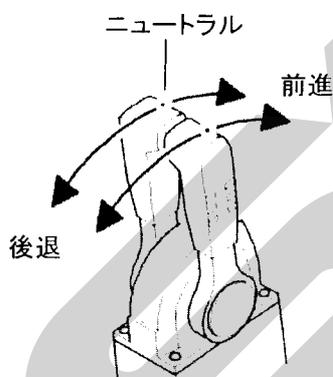
左右のステアリングレバーを同時に前に押すと前進、手前に引くと後退します。
