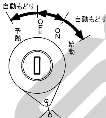
「予熱」にするとエンジンは予熱され、「始動」にするとセルモータが回転してエンジンが始動します。「ON」位置では各種電装品が作動します。「OFF」位置にすると、エンジンは停止し電気回路が切れます。この位置でキーの抜き差しができます。
