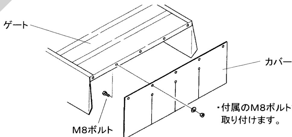
・付属のM8ボルトでカバーを取り付けます。
