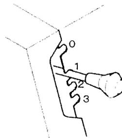
フロアコンベア速度調整レバー
