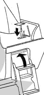
解除レバーを矢印方向に押すとロックが解除され、ステップが飛び出します。
