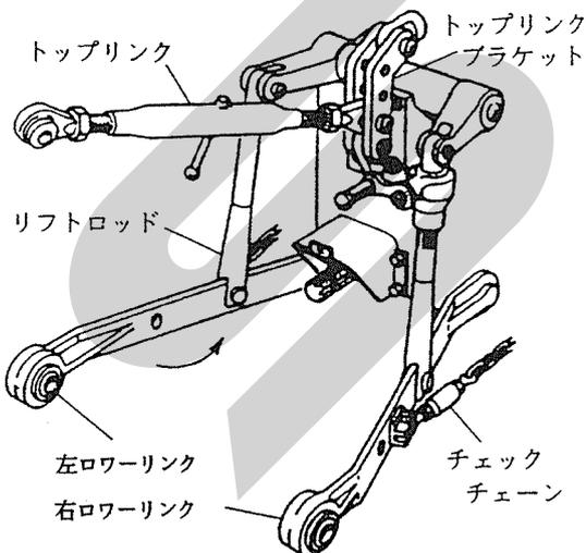
特殊3点リンク式のロータリを使用している場合には、トップリングの連結部を外し、標準3点リンク用の長いトップリングを使用してください。
