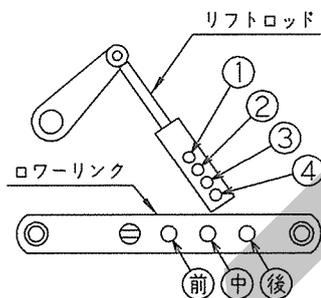
3点リンク最上時、シャッター開閉レバーがトラクタに干渉するものがあります。純正ロータリー用ヒッチ以外で本作業機を装着する場合は、リフトロッド穴を4（最下）、ローリンク穴を後で装着してください。
