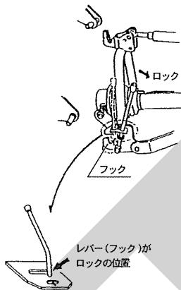
(10) PIC軸芯がトラクタ中心におおよそ一致するようにチェックチェーンでセットし、ブロードキャスターの横振れをなくしてください。
