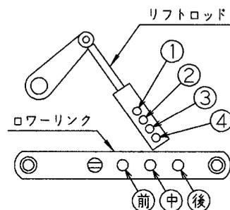
3点リンク最上時、シャッタ開閉レバーがトラクタに干渉するものがあります。純正ロータリ用ヒッチ以外で本作業機を装着する場合は、リフトロッド穴を4（最下）、ローリンク穴を後で装着してください。
