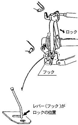
(10) PIC軸芯がトラクタ中心におおよそ一致するようにチェックチェーンでセットし、ブロードキャストの横振れをなくしてください。
