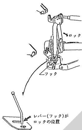
(10) P I C軸芯がトラクタ中心におおよそ一致するようにチェックチェーンでセットしてブロードキャスターの横振れをなくしてください。
