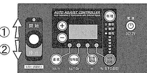
(1) レバースイッチを①「開始」側に倒すと、シャッタが開き肥料が散布されますので、走行を開始してください。
