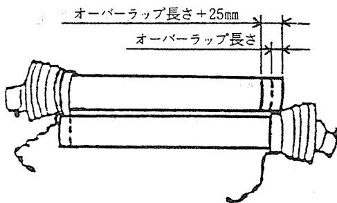
⑤ 3点リンクを昇降させて、PTO軸とPIC軸が最も離れる位置で、昇降を停止してください。
