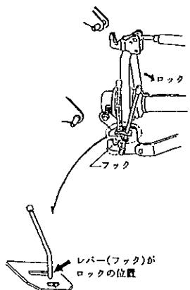
(10) PIC軸芯がトラクタ中心におおよそ一致するようにチェックチェーンでセットしてブロードカスターの横振れをなくしてください。
