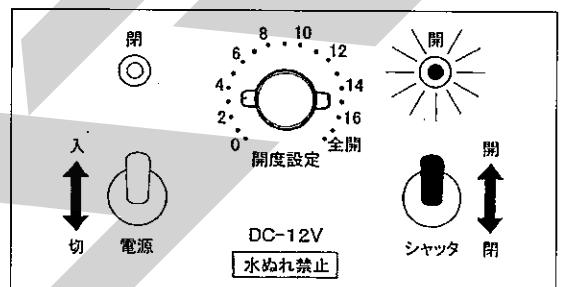
(4) シャッターを閉じるときは、開閉スイッチを「閉」にします。このときチェックランプの「閉」が点滅します。動作が完了するとチェックランプの「閉」が点灯します。
